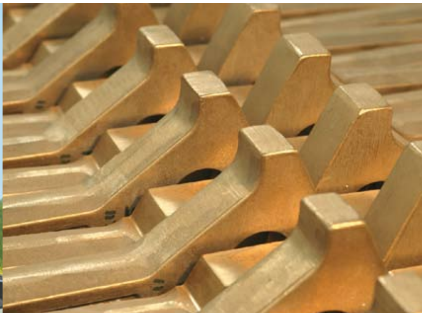
Verschlußklinken nach der Bearbeitung in unserer Schweizer Fertigung
